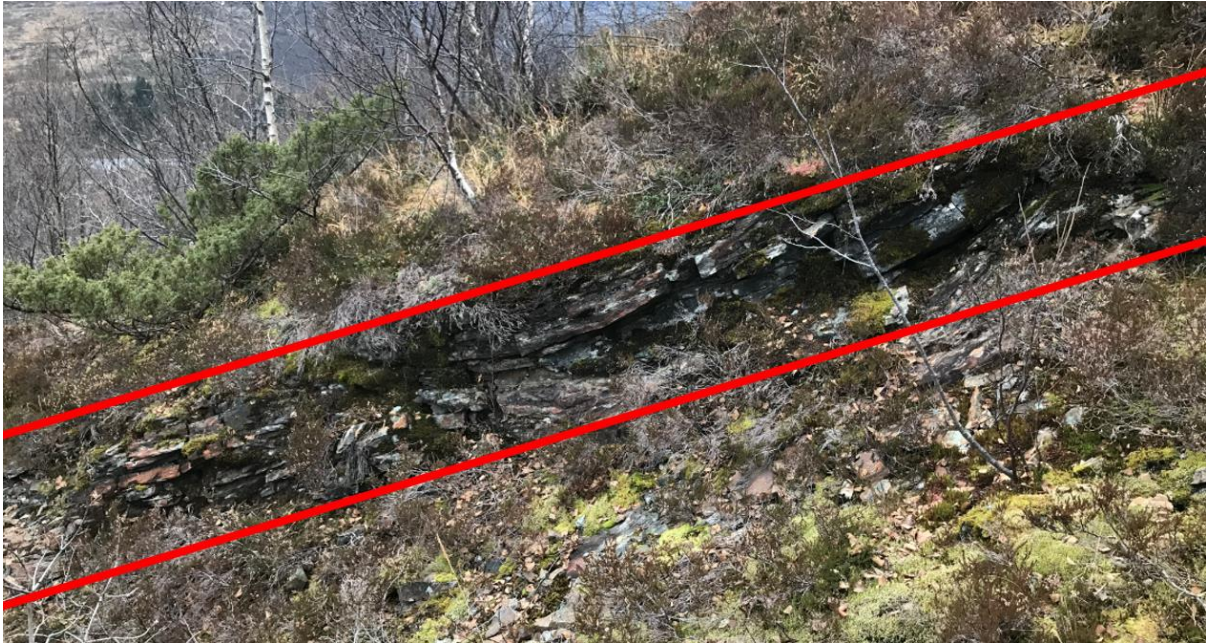
Figur 15: Vertikalsnitt av berggrunnsoverflate med sterkt oppsprukke forvittringsprofil (Mellom dei raude linjene).
