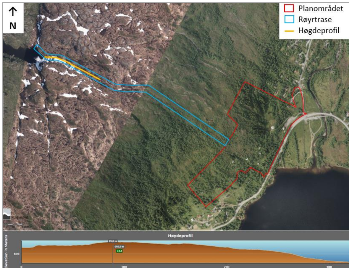
Figur 12: Flyfoto som viser inntak i Setratjørna og rørtrase ned til planområdet.
